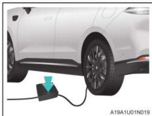
4. شغل السيارة، ثم شغل المفتاح الخاص بمضخة الهواء بدء النفخ.
