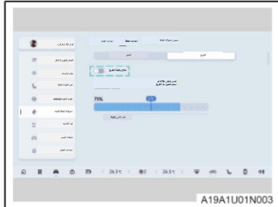
4. انقر فوق زر التفريغ الناعم الموجود على شاشة التحكم المركزية لتشغيل وظيفة التفريغ، ويبيّن المؤشر الأحمر الموجود على مقبس التفريغ ويربط الأجهزة الكهربائية.
