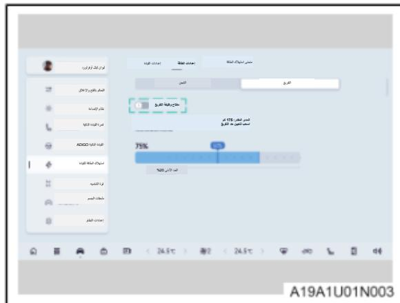
4. انقر فوق زر التفريغ الناعم الموجود على شاشة التحكم المركزية لتشغيل وظيفة التفريغ، ويضيء المؤشر الأحمر الموجود على مقبس التفريغ ويربط الأجهزة الكهربائية.
