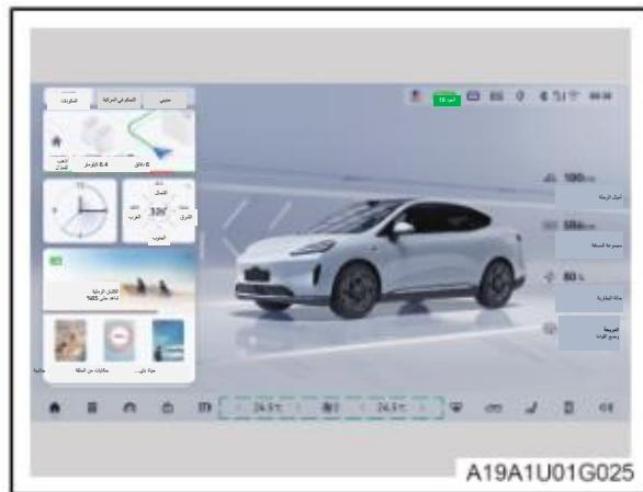
يمكنك من منطقة التحكم السريع في مكيف الهواء الموجودة أسفل شاشة التحكم المركزية تشغيل مكيف الهواء بسرعة، بعد تشغيله، اضغط لفترة طويلة أو اضغط باستمرار لسحب رقم درجة الحرارة أو حجم الهواء مباشر، وسيظهر مفتاح التحكم السريع. اسحب لليسار أو لليمين لضبط درجة حرارة مكيف الهواء أو حجم الهواء بسرعة.
