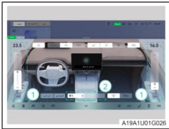
١ منطقة التحكم في درجة الحرارة، درجة حرارة تكييف الهواء قابلة للتعديل
